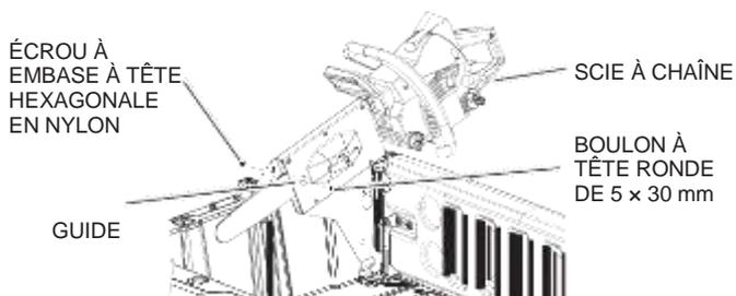
15. Fixez la scie à chaîne avec le câble de sécurité installé sur le support.
