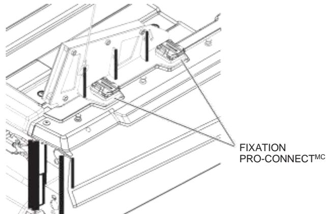
11. Poussez le support de caisse contre le support de scie à chaîne. Serrez le boulon de support de caisse (consultez le TABLEAU DE COUPLE DE SERRAGE).
