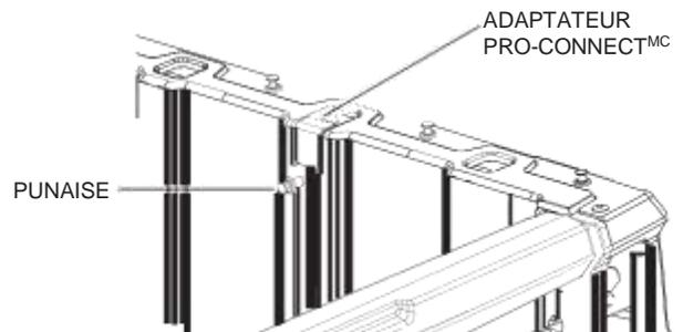
7. Retirez le matériel de fixation d'origine du coin arrière droit de la caisse.
