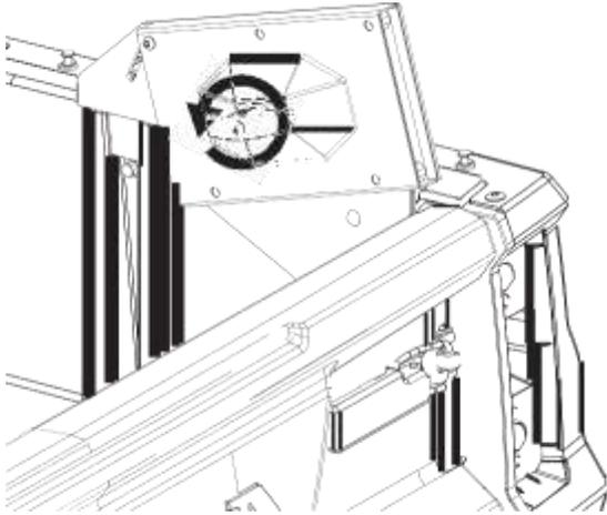
13. Placez la scie à chaîne dans le support de scie à chaîne. Tenez la scie à chaîne parallèlement au support de scie à chaîne, puis vissez la poignée du support de scie à chaîne pour maintenir la scie à chaîne en place.
