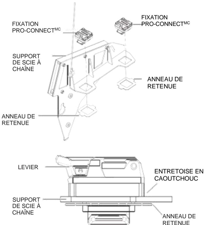
3. Retirez la pellicule de la bande autoadhésive en caoutchouc et collez-la au support de scie à chaîne dans la position illustrée ci-dessous.
