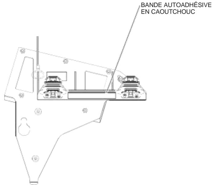
4. Installez le limiteur Pro-Connect<sup>MC</sup> sur la caisse. Marquez l'emplacement du centre de l'ouverture du limiteur. Retirez la pièce.
