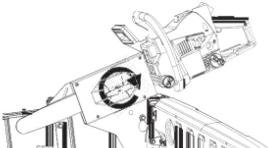
14. Réglez le guide de scie à chaîne le long de la fente pour vous assurer que la scie à chaîne est solidement en place à l'aide du boulon à tête ronde de 5 x 30 mm et de l'écrou à embase à tête hexagonale M6 en nylon (consultez le TABLEAU DE COUPLE DE SERRAGE).
