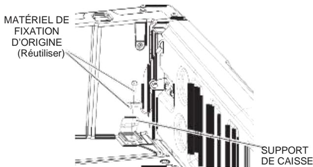
9. Installez le manchon sur la caisse à l'aide du boulon à embase à tête hexagonale de 10 x 30 mm (consultez le TABLEAU DE COUPLE DE SERRAGE).
