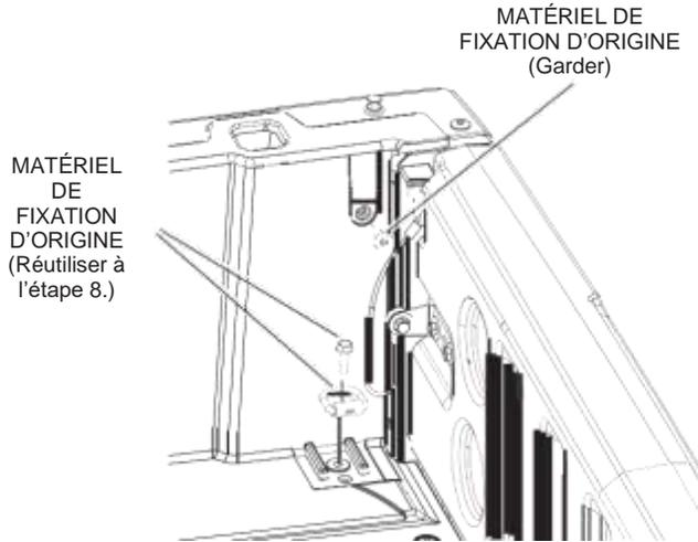
8. Installez le support de caisse sur la caisse en utilisant le matériel de fixation d'origine mentionné à l'étape 7 (serrer à la main seulement).
